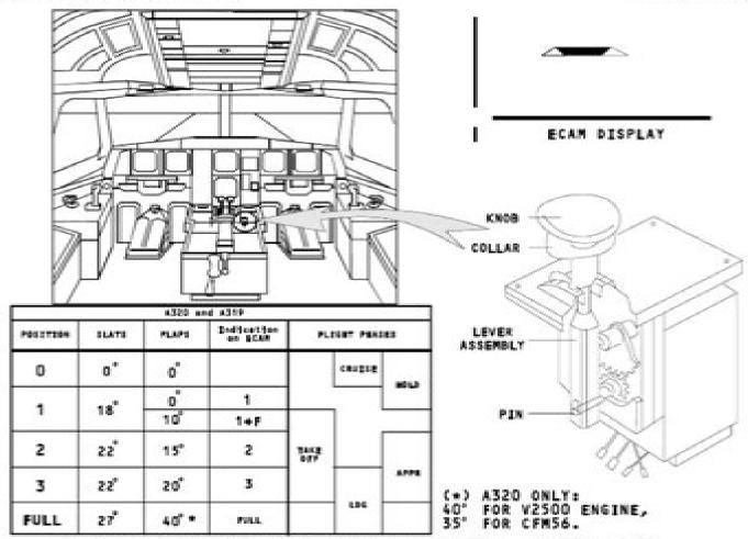
SLATS AND FLAPS CONTROL AND POSITION INDICATION - CONTROL LEVER
